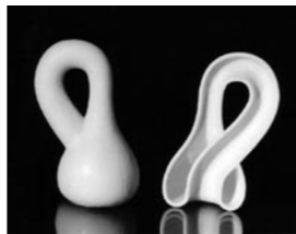
Bouteille de Klein et sa coupe transversale, impossible à mouler par des techniques conventionnelles. (Prototypage rapide)
