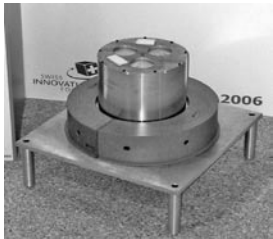
Frigo magnétique développé à la HEIG-VD, un des lauréats du Swiss Technology Award
