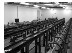
Lignes Hopkinson du Laboratoire DynaMat
